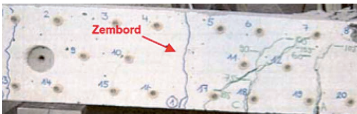
Bruchversagen bei Querkraft- und Momentenbeanspruchung mit ZEMBORD
