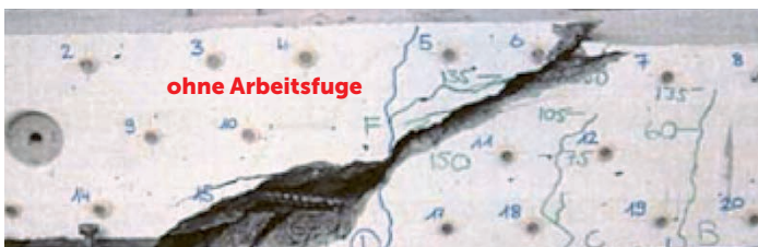
Bruchversagen bei Querkraft- und Momentenbeanspruchung ohne Arbeitsfuge
